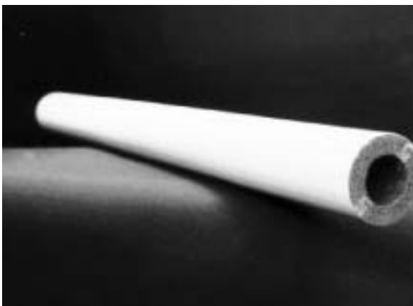
図4-2-1 セラミックフィルタの外観と断面
