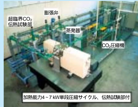
図1 CO 2 ヒートポンプ基礎実験ループ
