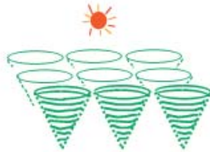
図4-5-2 クロレラを用いたCO 2 固定光バイオリアクターの概念図
