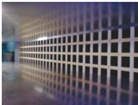
写真4-3-1 風洞吹き出し口（乱流格子設置状況）
