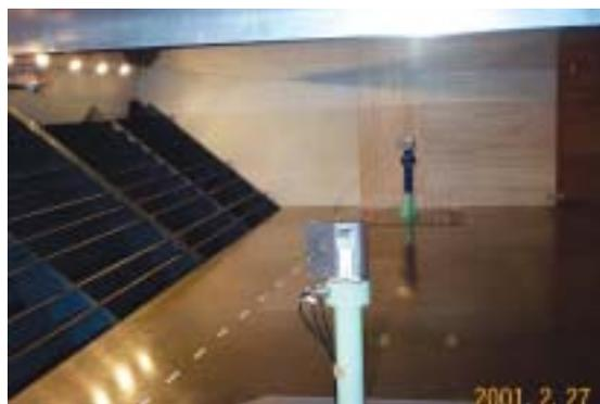
写真4-3-2 架渉線風応答実験の様子（耐長型）
