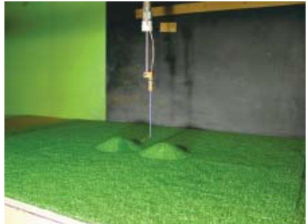
写真4-2-3 3次元2山地形模型実験状況
