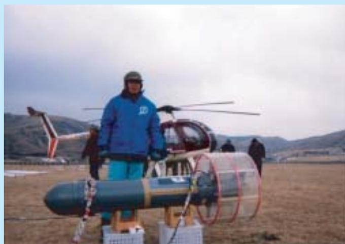
写真2 空中電磁法センサーボード
