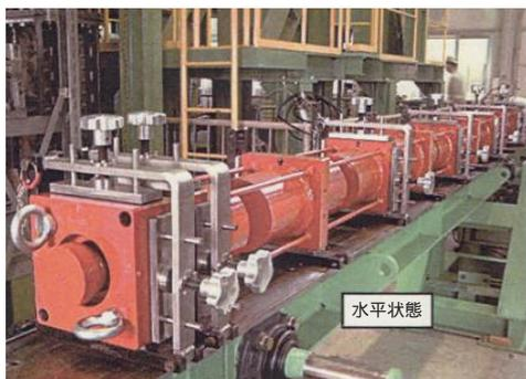
図7-3-5 等価模擬燃料体の基本構造
