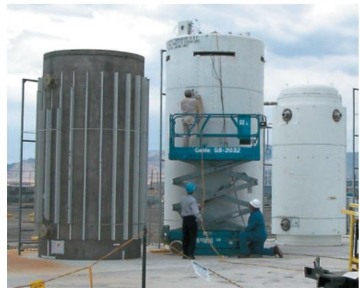
図7-2-1 コンクリートキャスクの非破壊検査の様子
