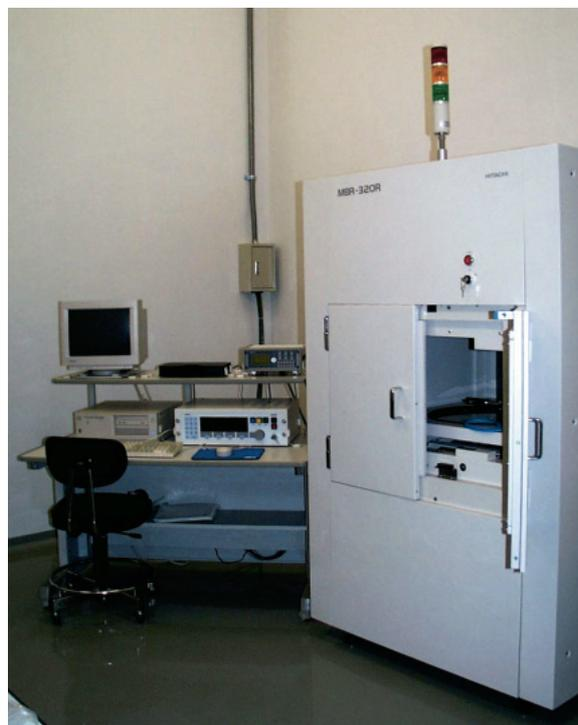
図1-1-5 X線照射装置
