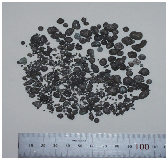
回転式熔融スラグ骨材化装置の運転条件 回転速度 : 3 rps 背面冷却水 : 50 l/min 噴霧冷却水 : なし
