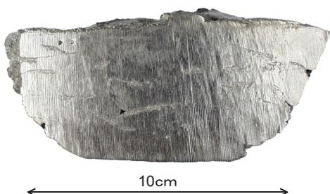
図2-2-2 逐次溶融で作製した溶融体断面 (ジルカロイ廃材 2kg、41MJ)
