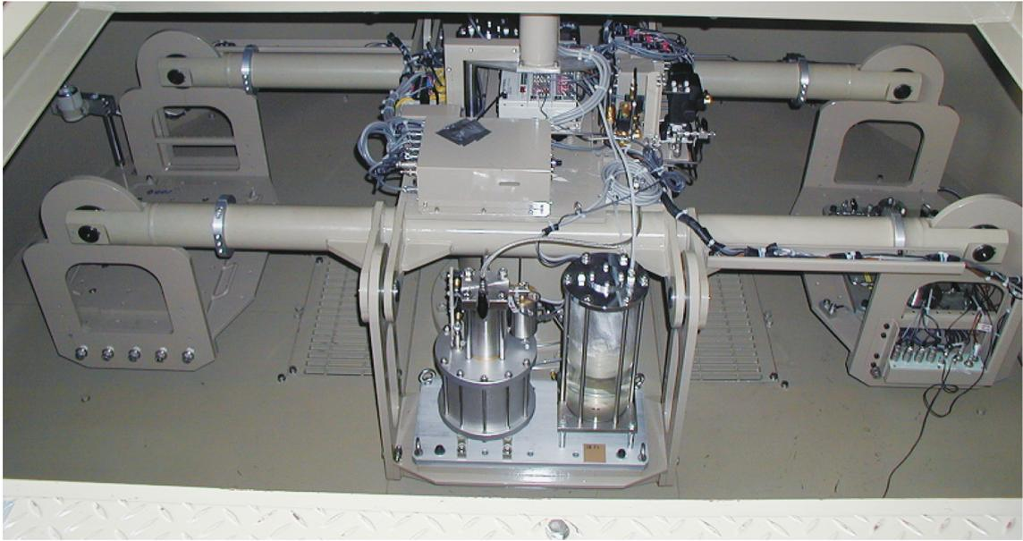
図 3-1-5 締固めたベンナイト上の廃棄体の長期沈下量を測定するための遠心载荷装置
