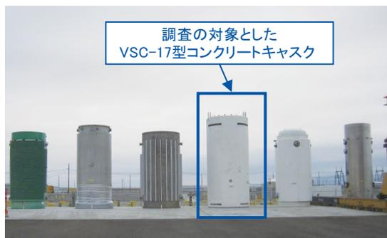
図7-3-2 アイダホ国立研究所で実貯蔵中のコンクリートキャスクを用いた実測試験
