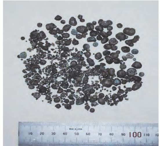
図5-1-6 回転式溶融スラグ骨材化装置で得られた球状のスラグ
