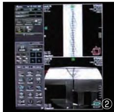
当所では、このような模型実験を行い、地下ですれた断層が地表に届くまでに、どのくらいの幅で亀裂が広がるのかを予測計算するための基礎データとしています。
