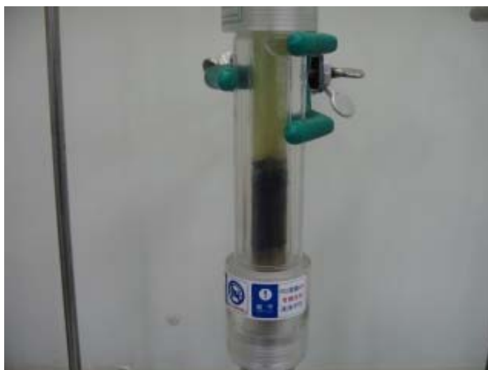
図5 カラムにDMEを下から上に流した様子 (下半分の濃い部分がアオコ。上半分の黄緑色の液体が、緑の原油を抽出したDME)
