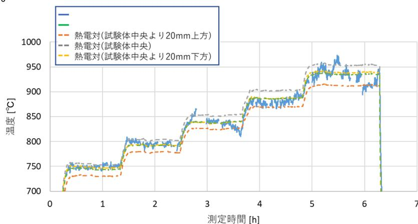
図 2：高温保持中の温度計測結果
