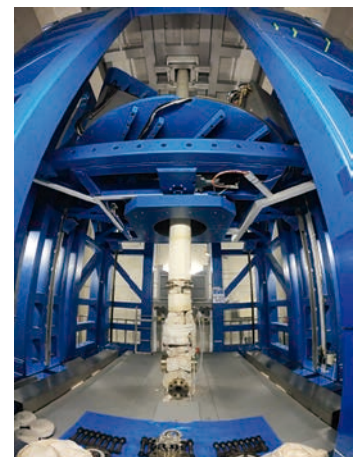
X線CT装置 青色のフレーム部が回転しながら 上下に移動し、中央白色の試験部分 のX線像を撮影する。
