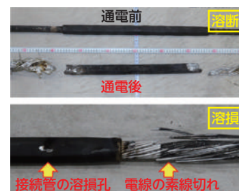
図2 事故電流通電後の溶断と溶損
