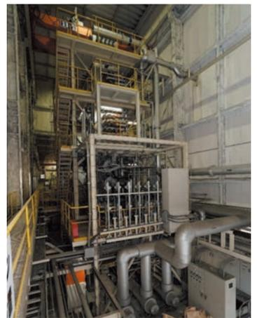
石炭燃焼特性実証試験設備
