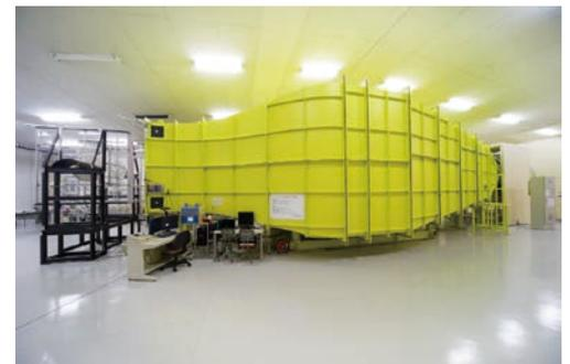
空気力载荷試験装置
